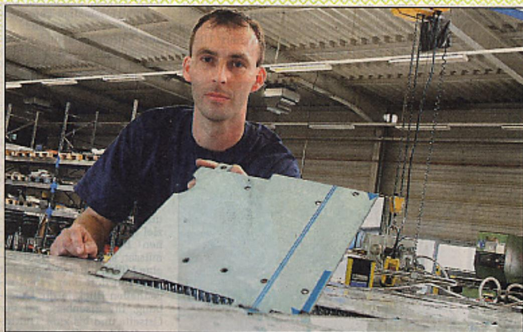
Maßgenau hat der Laser dieses Stück Edelstahl ausgeschnitten. Andreas Gumpert bedient die Maschine in der Firma CBV-Blechbearbeitung im Technologiepark Laasdorf. Am Samstag öffneten die dort ansässigen Firmen für künftige Lehrlinge – die leider ausblieben. Foto: Anja Büchner
