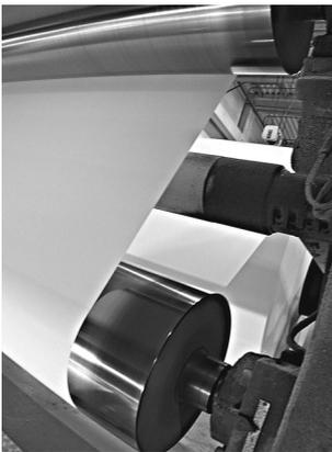
Den größten Teil einer Papiermaschine macht die so genannte **Trockenpartie** aus, bei der die Papierbahn slalomartig über erwärmte Rollen geführt wird, damit das Wasser bis auf eine geringe Restfeuchte verdampft. Durch die Wärme wird das Papier gleichzeitig verleimt, denn die beigemengten Leime schmelzen bei ca. 70 Grad Celsius. Am Ende der Trockenpartie hat das Papier einen Feuchtigkeitsgehalt von ca. 4 Prozent.
