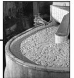
1680 Erfindung des "Holländers" (Lumpenmahlmachine), der statt des Stampfprinzips das Walzprinzip bei der Faseraufbereitung nutzt.
